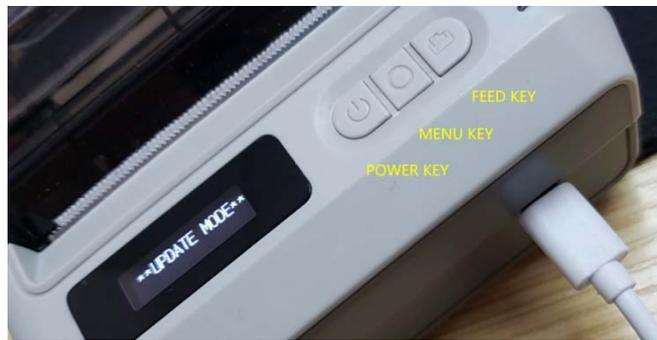
进入刷机状态后，不需要再操作打印机器，打印机处于等待刷机状态
